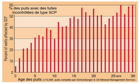
Le coffrage et le coulis du puits sont des ouvrages d'acier et de béton, qui se dégradent avec le temps, d'autant plus qu'ils sont exposés au sel des eaux souterraines. Un viaduc, composé des mêmes matériaux et exposé à un environnement salin, dure environ 50 ans. La dégradation inévitable du coffrage et du coulis laissera passer les fluides sous pression.
